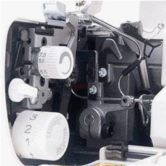
**Hilfsgreifer/Konverter:** Bei einer zweifädigen Naht läßt sich der Hilfsgreifer / Konverter der enspire ganz einfach zu schalten. Da er fest mit dem Obergreifer verbunden ist, kann man ihn weder verlegen noch verlieren.
