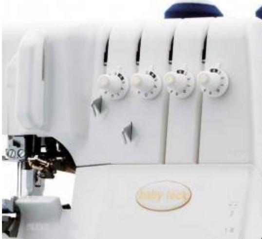
**Einstellmöglichkeiten:** Übersichtlich angeordnet sind die Einstellmöglichkeiten für Stichbreite und Stichlänge. Bei geschlossenen oder röhrenförmigen Kleidungsstücken können Sie das Messer ganz leicht und schnell mittels eines Schalters ausschalten und bei Verlangen wieder zuschalten. Als kleine Unterstützung ist das Messer so weit absenkbar, dass ein kleiner Anschlag als Führung übrig bleibt.
