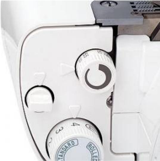
**Differentialtransport:** Wie oft hat man Probleme bei elastischen Stoffen, dass Sie am Ende des Nähens völlig kräuseln oder die Naht verschoben ist. Mit Hilfe des Differentialtransportes gewährleistet die enspire einen optimalen Stofftransport bei elastischen Stoffen und verhindert somit Nahtkräuseln oder überstehende Nähte. Auf Wunsch können Sie fantasievolle Kräuseleffekte erzielen, die Nähte dehnen oder eine gewünschte wellige Naht erzeugen.
