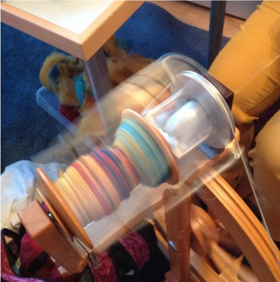
Dazu wird das gereinigte, gelockerte Faservlies oder - band gestreckt und mittels des Spinnrades gedreht. Die mit einander verbundenen einzelnen Haare werden so zu einem Faden.
