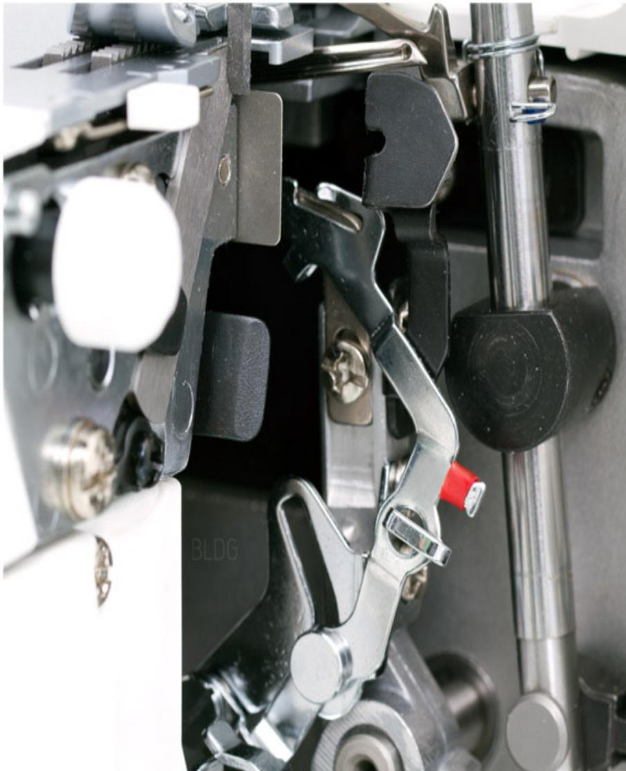
**Einfädelhilfe Greifer:** Angst vor dem Einfädeln brauchen Sie bei dieser Coverlock-[Nähmaschine](#) nicht zu haben. Die MO-735 ist leicht und schnell einzufädeln, folgen Sie einfach den Einfädelpunkten.
