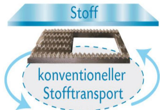
**Stahltransporteur:** Die JUKI Nähmaschine HZL-G220 verfügt dank eines speziellen 7-Punkt-Stahltransporteurs über einen starken Stofftransport. Projekte von schweren Stoffen bis hin zu leichten Stoffen lassen sich somit sehr gut transportieren und nähen. Zwei zusätzliche Transporteure vor der Nadel ermöglichen einen leichten Nähbeginn.
