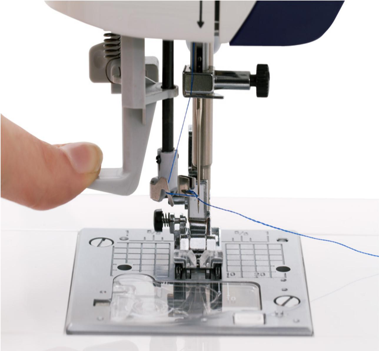
**Einfacher Nähbeginn:** Den [Knopf](#) am [Nähfuß](#) drücken und den Fuß parallel zur [Stichplatte](#) bringen. Dies ermöglicht einen einfachen Nähbeginn bei mehreren Stofflagen oder überlappenden Materialien und schweren Stoffen.
