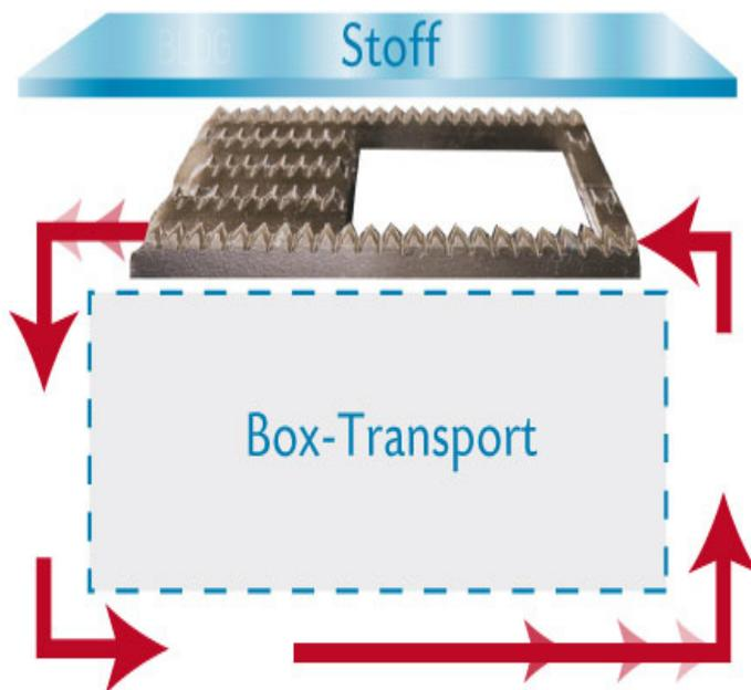
Da der Transporteur länger Kontakt zum Stoff hat, transportiert die Maschine das Nähobjekt besser.
