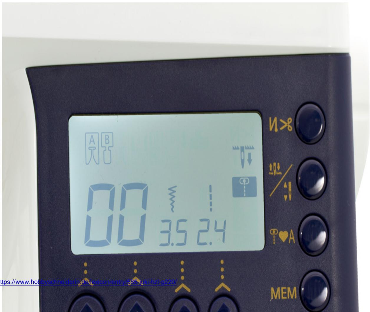
**Elektronische Geschwindigkeitskontrolle:** Die stufenlose Einstellung der Nähgeschwindigkeit erlaubt Ihnen auch bei schwierigen Nähprojekten, sicher und genau die Arbeiten zu beenden. Bei Bedarf kann Sie auch, dank der elektronischen Geschwindigkeitskontrolle, ohne Fußanlasser nähen.
