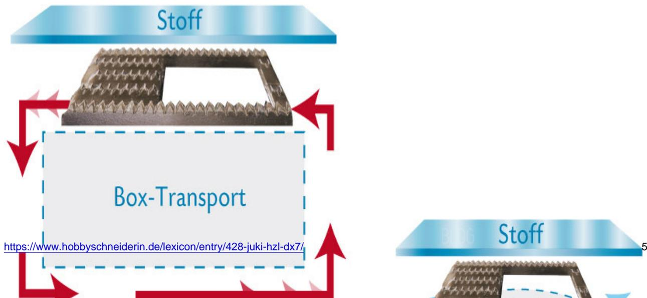
**Stahltransporteur:** Die JUKI Nähmaschine HZL-DX7 verfügt dank eines speziellen 7-Punkt-Stahltransporteur über einen starken Stofftransport. Projekte von schweren Stoffen bis hin zu leichten Stoffen lassen sich somit sehr gut transportieren und nähen. Zwei zusätzliche Transporteure vor der Nadel ermöglichen einen leichten Nähbeginn.
