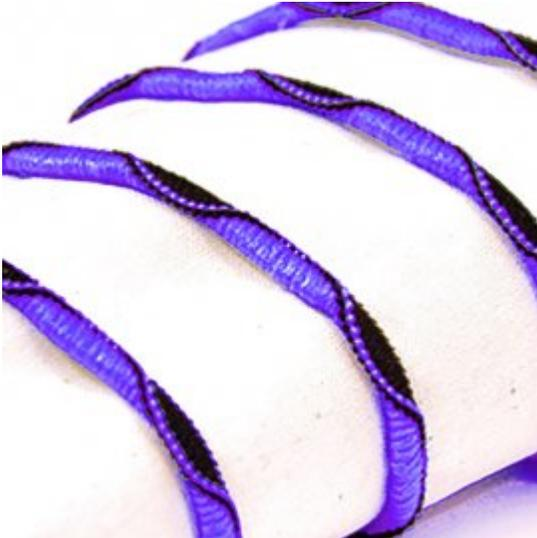
**Differentialtransport:** Mit Hilfe des Differentialtransportes gewährleistet die Gloria einen optimalen Stofftransport bei elastischen Stoffen und verhindert überstehende Nähte. Auf Wunsch können Sie fantasievolle Kräuseleffekte erzielen, die Nähte dehnen oder eine gewünschte wellige Naht erzeugen.
