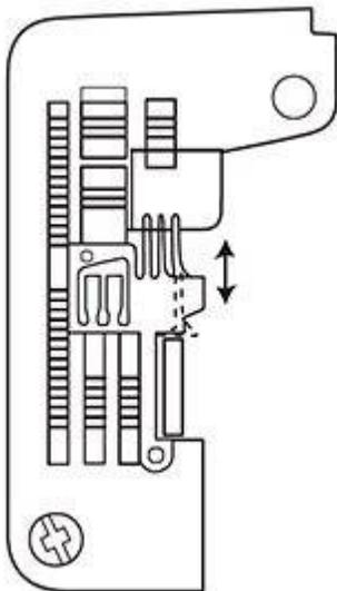
**Stichbreite:** Messer und [Kettelfinger](#) bewegen sich miteinander. Dadurch verändert sich die Nahtbreite und nicht nur wie herkömmlich die Schnittbreite. Somit werden Überschnitte bzw. Unterschnitte verhindert. Die Einstellung der Schlingfadenmenge entfällt. Der Stich wird breiter oder schmaler ohne lästiges und
