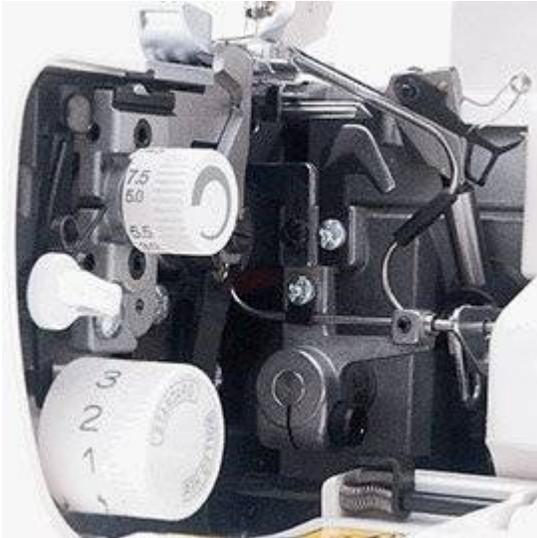
**Hilfsgreifer/Konverter:** Bei einer zweifädigen Naht läßt sich der Hilfsgreifer / Konverter der imagine ganz einfach zu schalten. Da er fest mit dem Obergreifer verbunden ist, kann man ihn weder verlegen noch verlieren.
