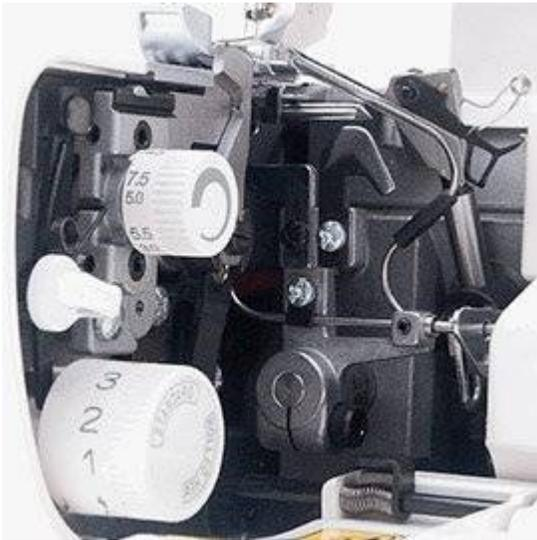
**Hilfsgreifer/Konverter:** Bei einer zweifädigen Naht läßt sich der Hilfsgreifer / Konverter der enlighten ganz einfach zu schalten. Da er fest mit dem Obergreifer verbunden ist, kann man ihn weder verlegen noch verlieren.
