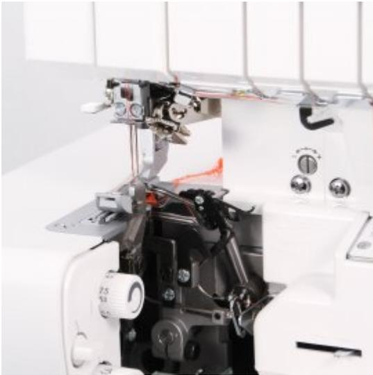
**Hilfsgreifer/Konverter:** Bei einer zweifädigen Naht lässt sich der Hilfsgreifer / Konverter der Victory ganz einfach zu schalten. Da er fest mit dem Obergreifer verbunden ist, kann man ihn weder verlegen noch verlieren.
