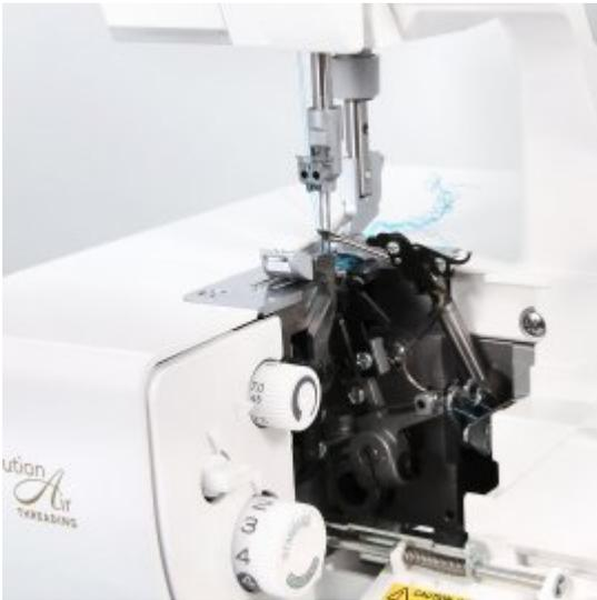
**Hilfsgreifer/Konverter:** Bei einer zweifädigen Naht lässt sich der Hilfsgreifer/Konverter der Acclaim ganz einfach zu schalten. Da er fest mit dem Obergreifer verbunden ist, kann man ihn weder verlegen noch verlieren.
