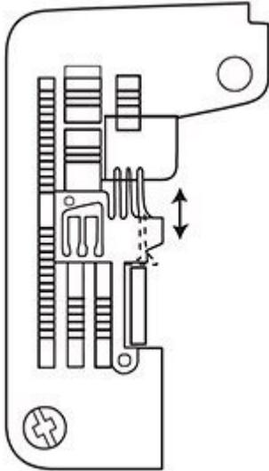
**Stichbreite:** Messer und **Kettelfinger** bewegen sich miteinander. Dadurch verändert sich die Nahtbreite und nicht nur wie herkömmlich die Schnittbreite. Somit werden Überschnitte bzw. Unterschnitte verhindert. Die Einstellung der Schlingfadenmenge entfällt. Der Stich wird breiter oder schmaler ohne lästiges und aufwendiges Einstellen.
