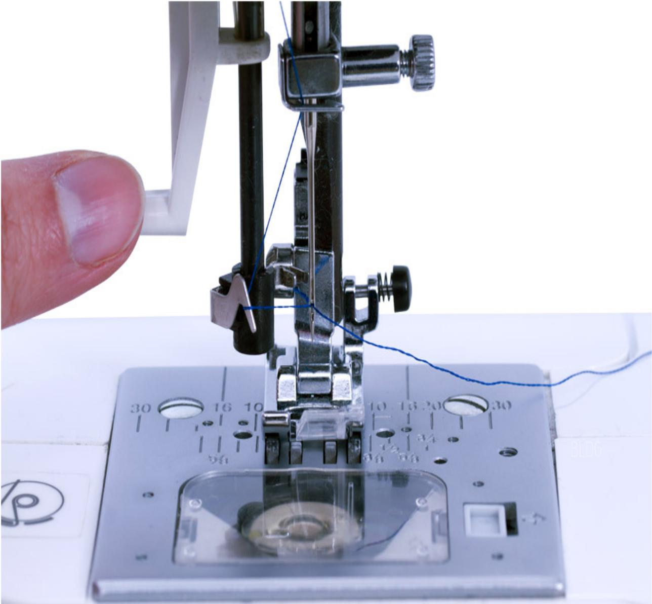
**Unterfadenspule:** Schnelles und einfaches Austauschen der Unterfadenspule und Reinigen der Greiferbahn. Mit Hilfe des Sichtfensters können Sie den Füllstand der Unterfadenspule prüfen.
